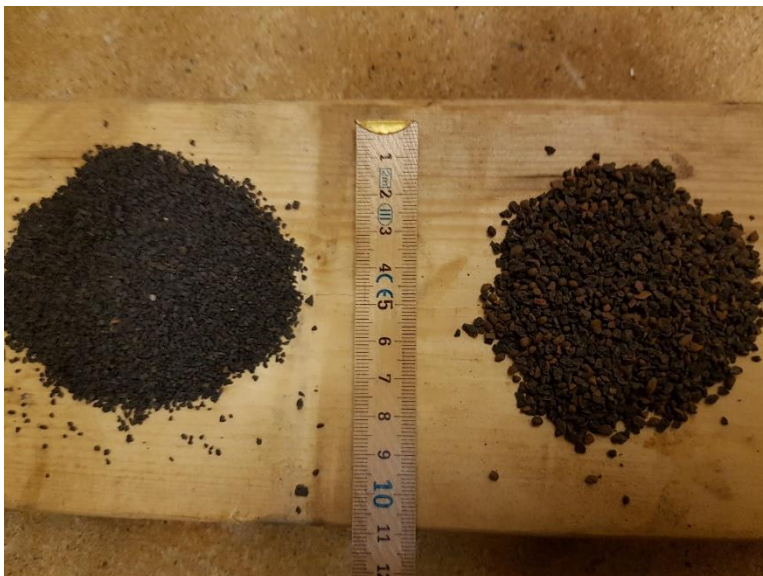
Figur 9: De två Filtralite-materialen som pilotfiltret fylldes med, Filtralite® HC 0,8-1,6 till vänster och Filtralite® NC 1,5-2,6 till höger.
