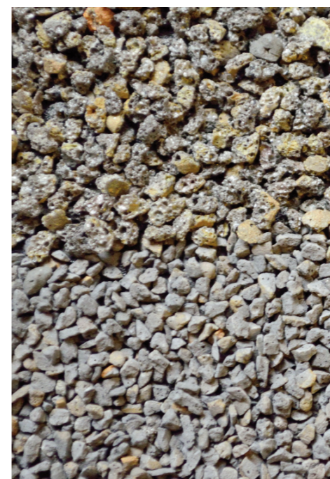
MONO-MULTI : Filtralite en fonctionnement. Observez sa nature poreuse et ses couches distinctes
