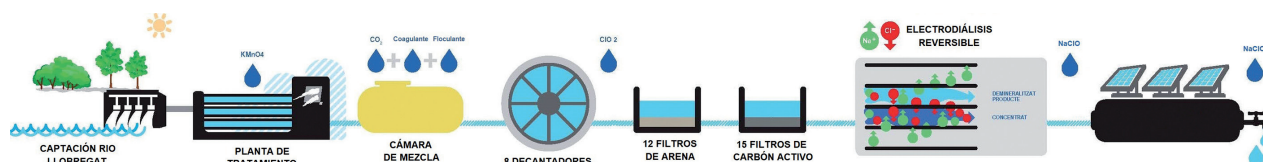
FIGURA 1. Proceso de tratamiento de la ETAP Llobregat.
